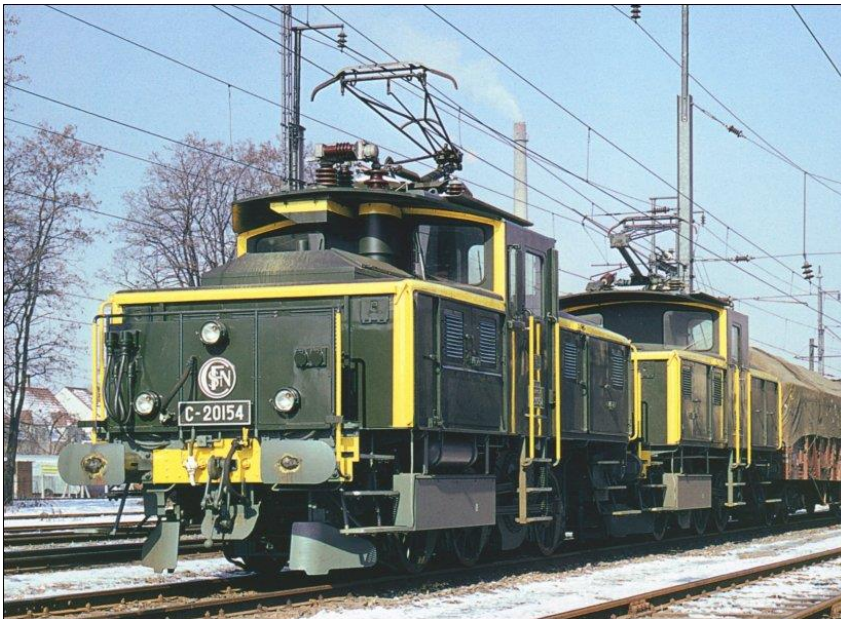
Zweifrequenz Lokomotiven C-20150 in Saint-Louis – Locomotives bi-fréquences C-20150 en UM à Saint-Louis (SAAS)
