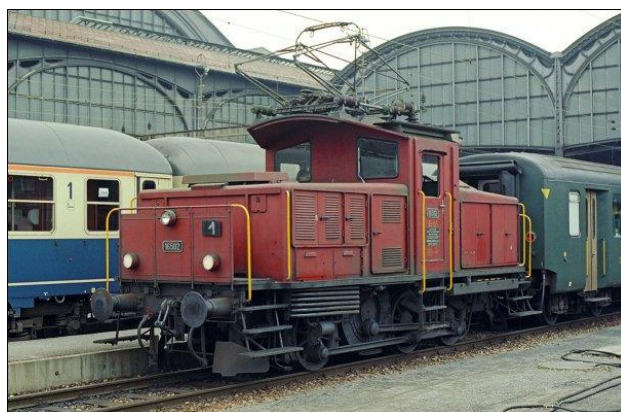
Locomotive bi-fréquence Ee 3/3'' 16502 à Bâle Zweifrequenz Rangierlok Ee 3/3'' 16502 in Basel (Auteur inconnu – Autor unbekannt)
